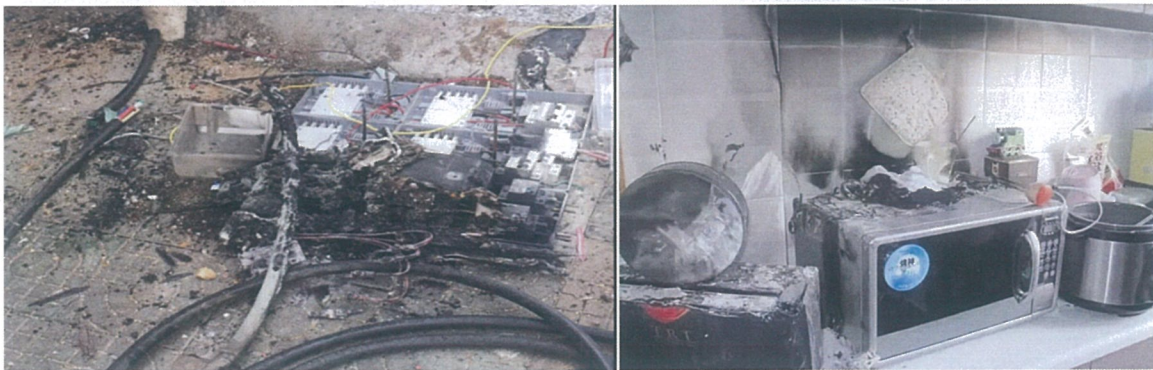
图 D. 6-1、图 D. 6-2 电路短路引起的起火
