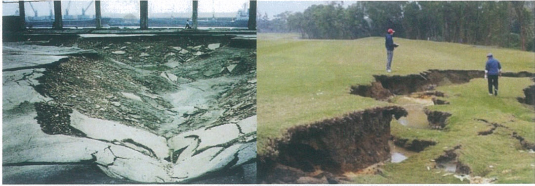
图 D. 1-13、图 D. 1-14 地基液化（地震时发生）
