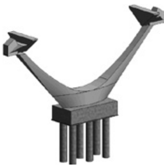
图 E.2.3 “V”型桥墩深化设计模型图
